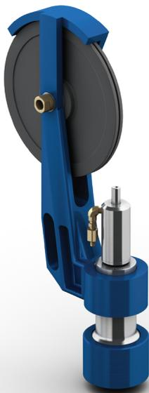
**El Stuffing Box hidráulico para Slickline de Hunting contiene la presión del pozo mientras la línea de Slickline está en movimiento o quieto y también guía al Slickline desde la polea simple inferior hacia la parte superior del lubricador.**
