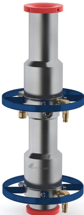
**El cabezal de control de presión PCH Stripper doble de Hunting está diseñado para sellar alrededor de los nuevos cables eléctricos recubiertos de polímero haciendo uso de elementos elastoméricos que impiden que los fluidos y/o gases confinados dentro del lubricador contaminen la instalación del pozo a medida que se sube o baja el cable en el pozo.**
